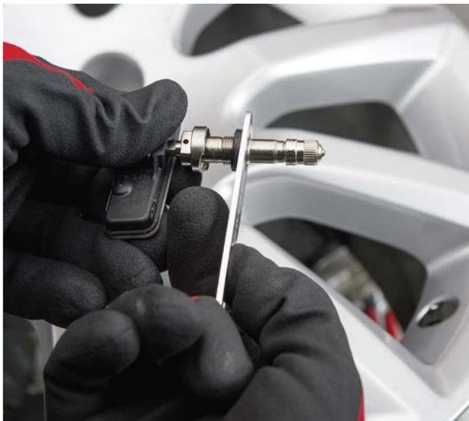
Fijación de Válvula de goma de en el sensor de control de presión de los neumáticos con 1,4 Nm Art. N° 0714 71 91
