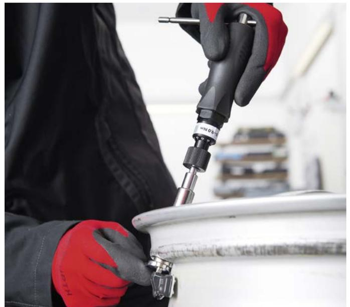
Para Apriete la tuerca de unión de la presión del neumático del sensor de monitorización con 8,0 Nm Art. N° 0714 71 92
